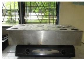
Gambar 3. Waterbath yang digunakan untuk meleburkan balsem
